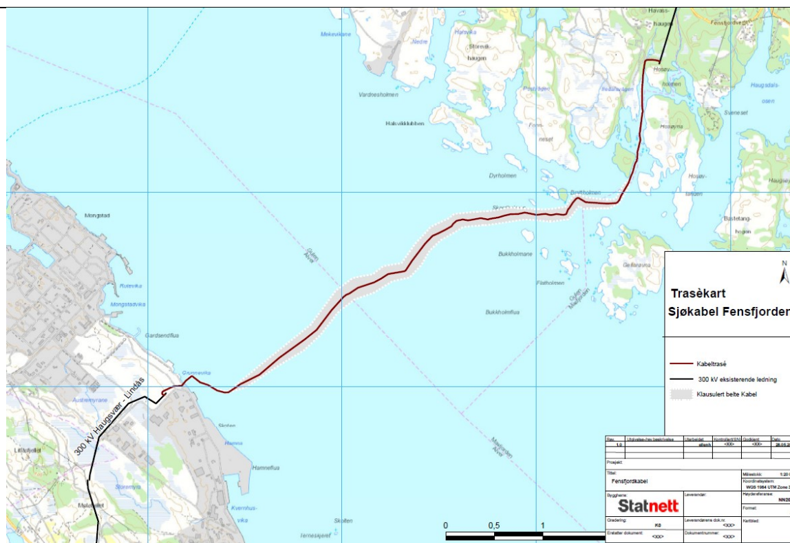
Kart 1: Trasé for ny 420 kV sjøkabel over Fensfjorden. Kilde: Statnett SF sin søknad.
