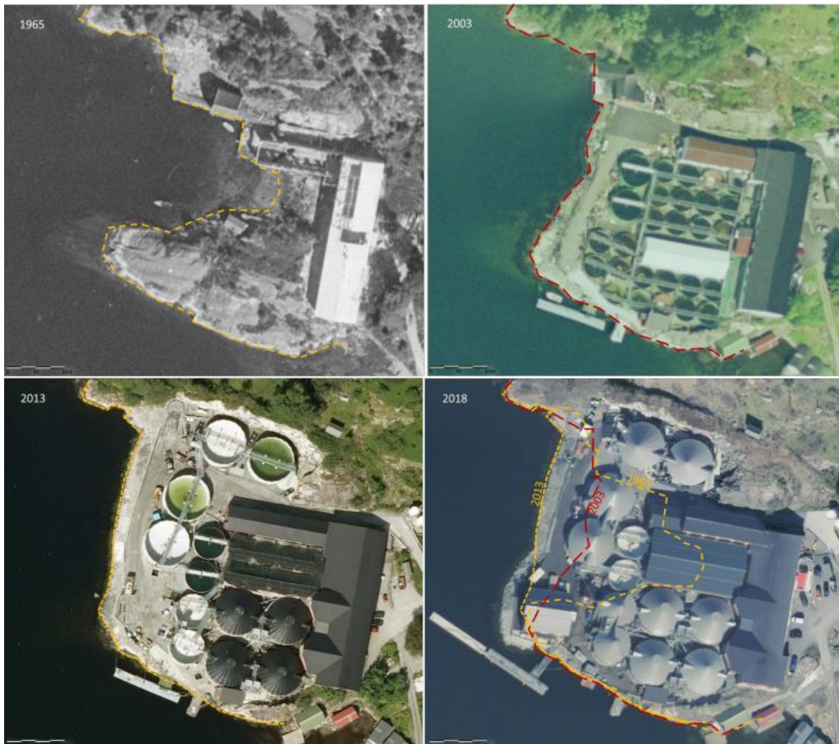
Figur 6. Flyfoto fra 1965, 2003, 2013 og 2018 hentet fra rapporten til EADU AS [4]. Flyfoto fra 1965 indikerer sjøkant før fylling. Berg er synlig i dagen. Flyfoto fra 2003 viser fyllingskant, denne blir utvidet i 2013 med lokal stein fra sprengt fjell nord i settefiskanlegget. Flyfoto fra 2018 viser utvidelsen av settefiskanlegget fra 1965-2013 med stiplede linjer.
